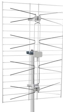
Antenna a singolo pannello di banda UHF con connettore F, filtro 4G LTE e elementi radianti in acciaio
